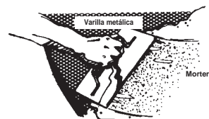
Figura 8 Aplicación de mortero con un fratacho o llana
