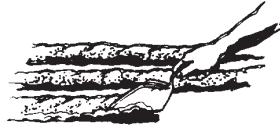
Figura 21 Colocación de mortero para instalar las piedras para hogares
